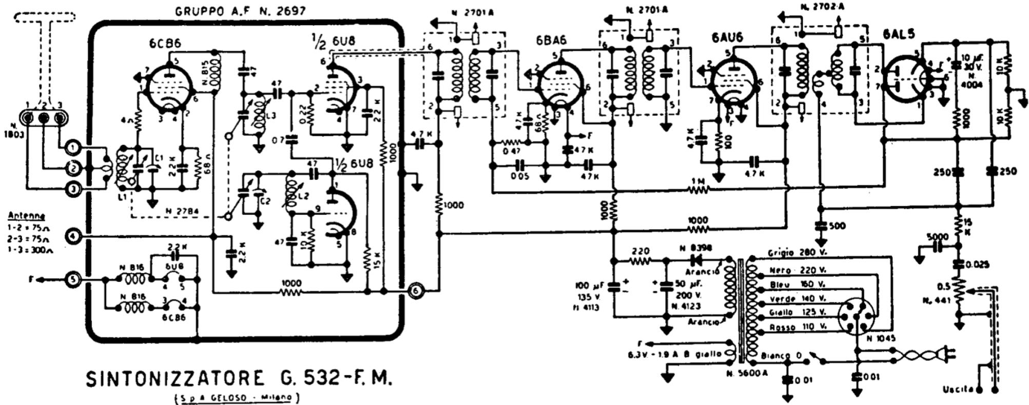
**GELOSO - Sintonizzatore a modulazione di frequenza mod. G. 532 FM. Funziona collegato all'entrata di un amplificatore o alla presa fono di apparecchio radio AM. Gamma: da 88 a 108 Mc/s. MF a 10,7 Mc/s. Sensibilità d'antenna 6 μV. Uscita BF da 5 a 7 mV.**
